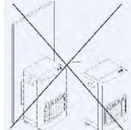
5. Neumisťujte kamna podél zdi nebo v blízkosti záclon a jiných hořlavých materiálů. Minimální vzdálenost by měla být respektována: 20 cm od bočních stran, 150 cm od přední strany. VŽDY směřujte na střed místnosti. Zvláštní pozornost věnujte v případě, že kamna stojí na povrchu, kde se mohou otočit na kolečkách, pokud o ně zavadí dítě nebo pes, atd.
